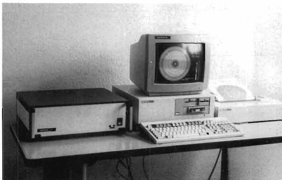
Figure 3. – LE SYSTÈME SANAGA : de gauche à droite, le module d'interface et de numérisation, le micro-calculateur, l'imprimante.
