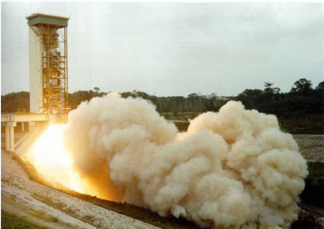
Essai de Booster au BEAP (cliché CSG)
