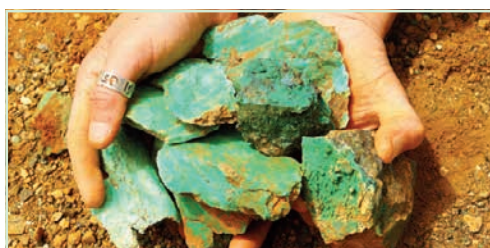
Figure 2.12 : Garniérite (phyllosilicate double de nickel et de magnésium).
