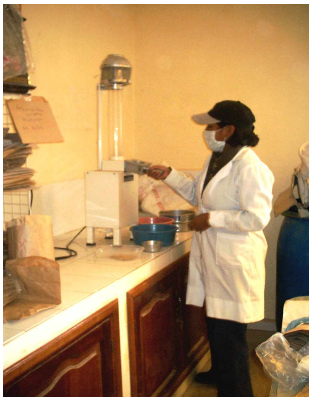
Foto 15. Venteo de los granos en venteadota eléctrica.
