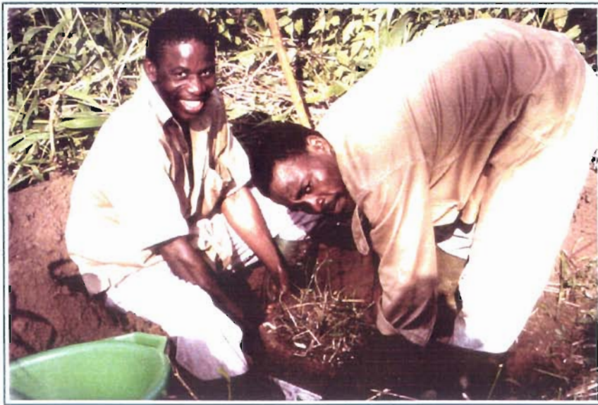
Photo 7 - Prélèvement d'un monolithe de sol (25x25x30 cm) en milieu naturel
