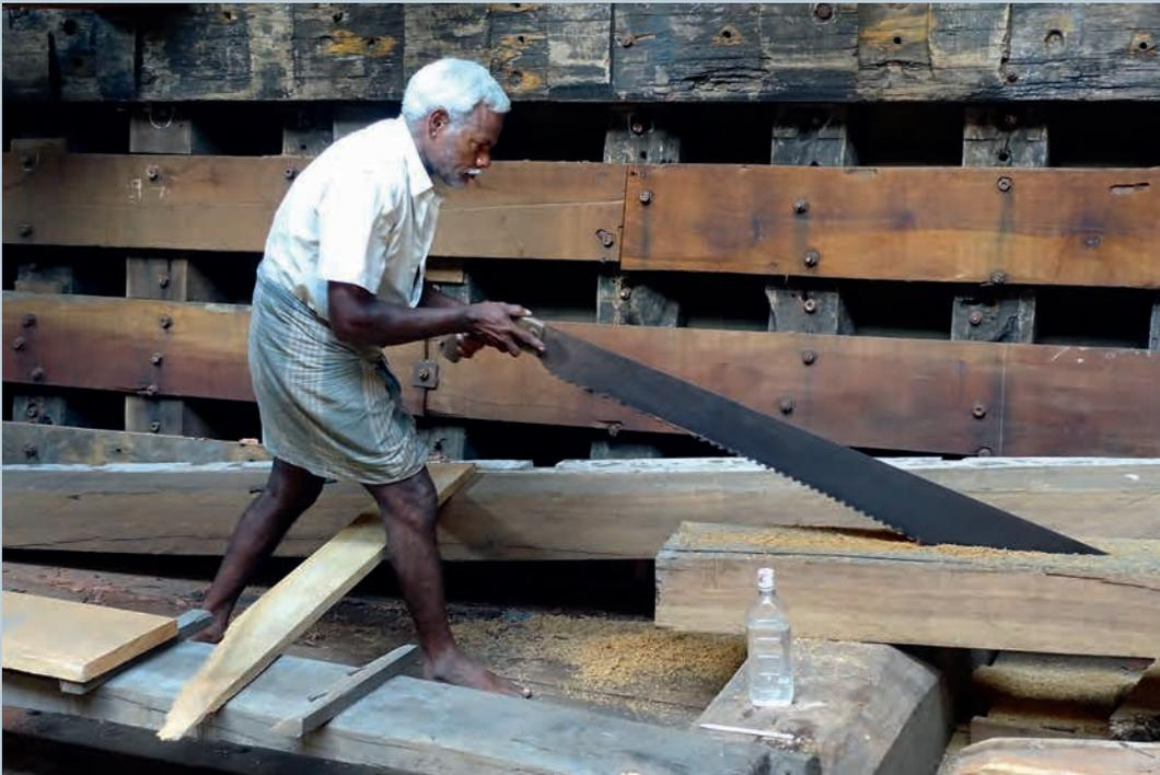
5. **Charpente d'un kotia en cours de construction**
