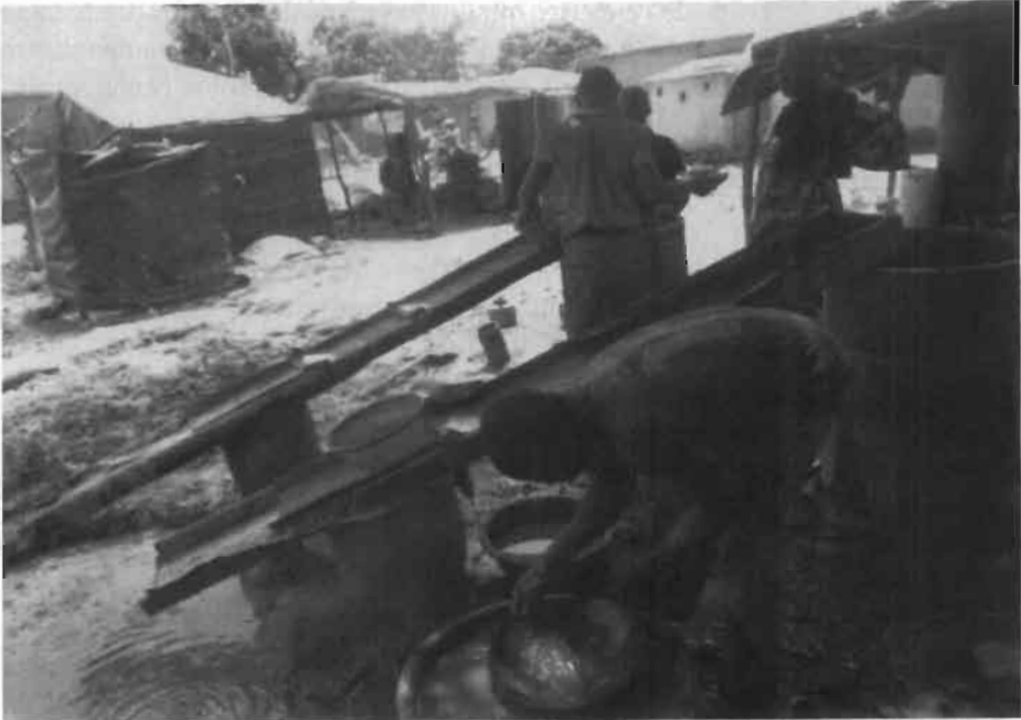
Figure 3 – Un sluice box pour le lavage du minerai à Tonso
