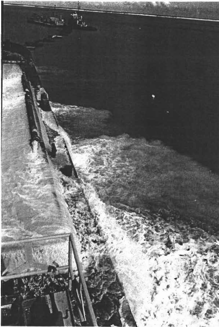
Fig. 9.- Panache turbide induit par la surverse lors du chargement du chaland. Photo : G. Bargibant - ORSTOM
