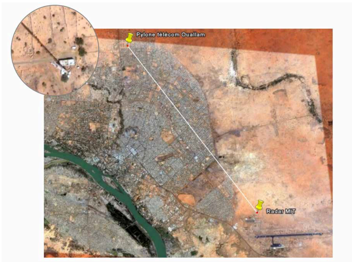
Figure 48 : Image satellite (source Google Earth) de Niamey avec les marqueurs de position du radar (13°29'29.57"N, 2°10'11.33"E) et du pylône de télécommunication (13°33'35"N,2°6'52"E). Le trait blanc représente la radiale radar d'azimut 322° comprenant la réflectivité rétrodiffusée par la structure métallique. Sur l'image grossie, en haut à gauche, est visible le pylône blanc et son ombre projetée au sol.
