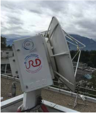
Figure 7 : Xport, radar polarimétrique bande X, sur le toit de l'IGE à Grenoble.
