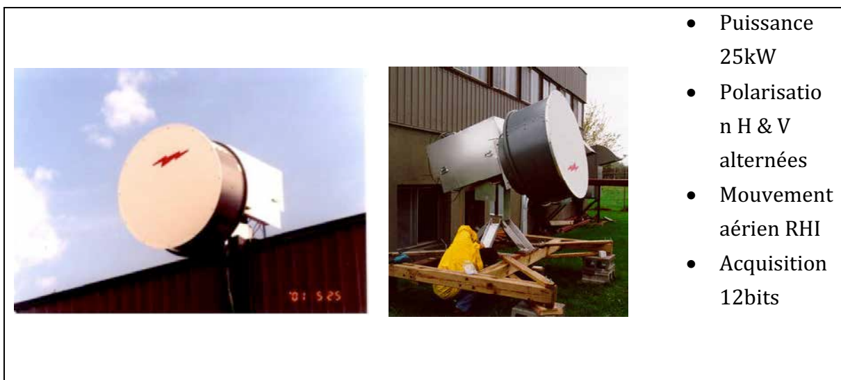
Figure 6 : vues du radar Xpolito et description de ses principales caractéristiques.
