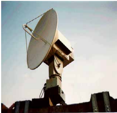
Figure 4 : XNT, radar bande X du LTHE fabriqué par Gematronik ayant fait l'objet d'une réfection importante en de 1996 à 1998.
