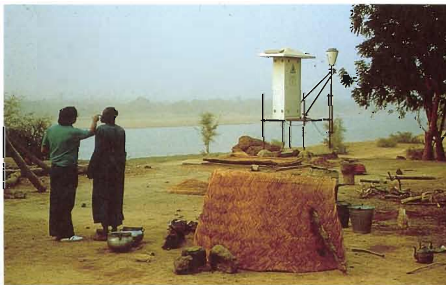
Station hydropluviométrique télétransmise
