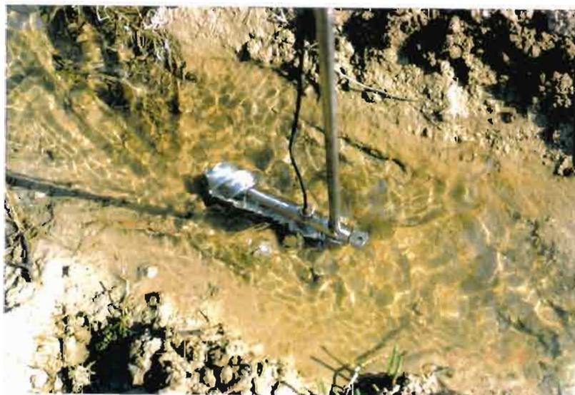
**Photo.2- Mesure du débit de drainage secondaire au moulinet.**
