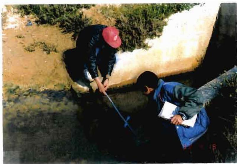
**Photo.1- Mesure de la conductivité électrique de l'eau du drain principal.**
