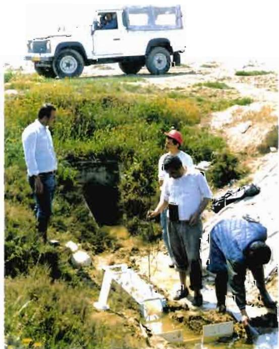
**Photo.3- Etalonnage du moulinet par rapport au seuil jaugeur.**
