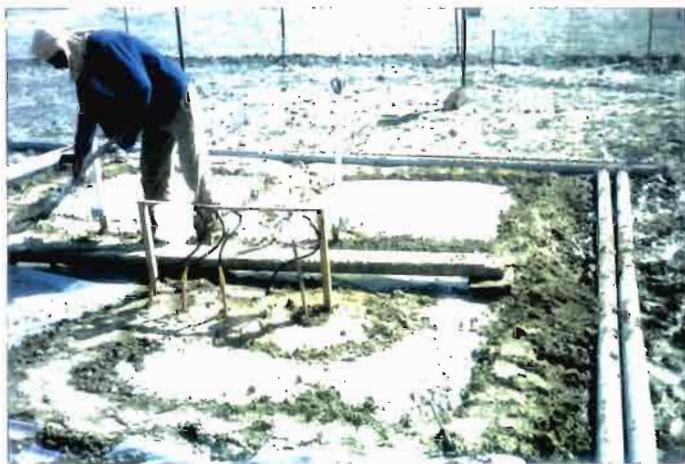
Photo.3- Installation des tensiometres à Zelba.
