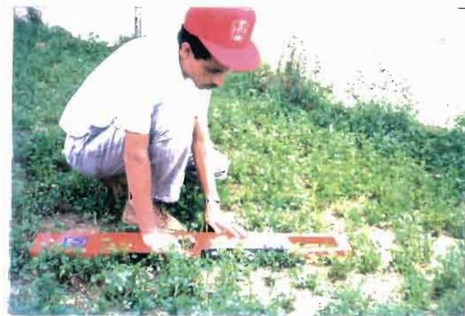
Photo.5- Mesure de CEM en mode horizontal à Zelba.
