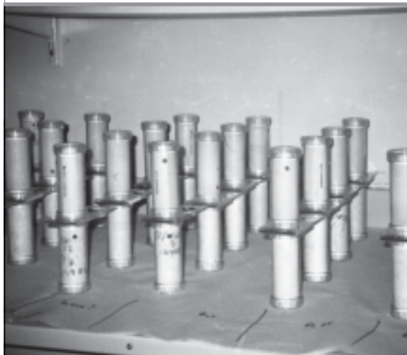
Cylindres-tests OMS utilisés pour la sélection de la souche Kou et pour mesurer la sensibilité des moustiques aux insecticides.
