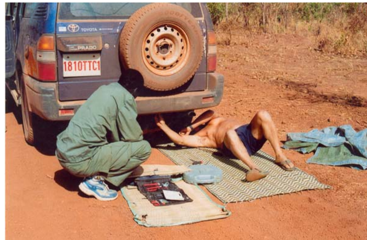
Re-fixation du réservoir de carburant
