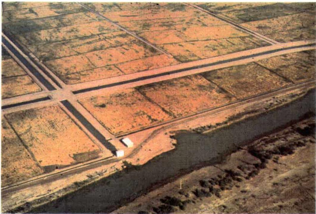
PHOTO 12. Aménagements hydro-agricoles tertiaires avec station de pompage, canaux d'irrigation et de vidange sur chaque parcelle rizicoles (LAMPSAR)
