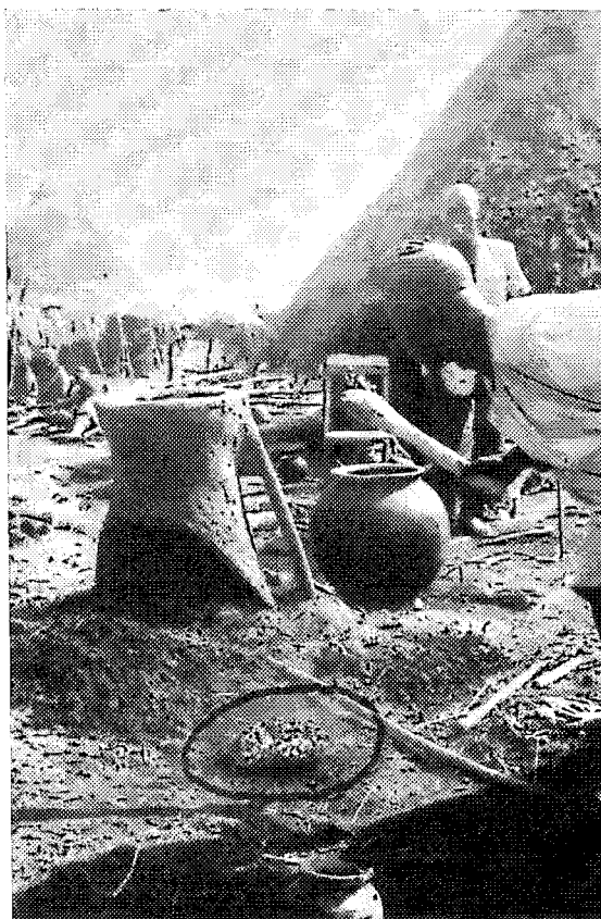
PHOTO 13. — Martellement du fer obtenu.
