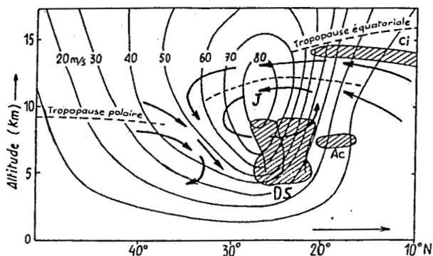
FIG. 3.—Coupe transversale du Jet Subtropical durant la saison fraîche; position d'une dépression subtropicale (DS); Ac, Altocumulus; Ci, Cirrus. Les flèches indiquent la circulation transversale au Jet avec développement de subsidence ou de convergence dynamique de part et d'autre de l'axe du Jet (adapté d'après Queney, 1974 et autres sources; Maley, 1981).
