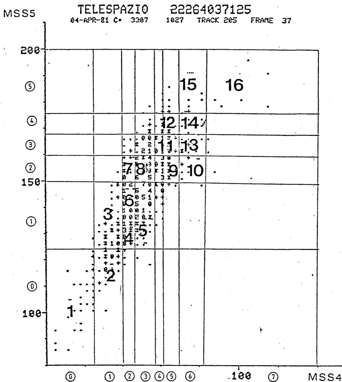
Fig. 2 : Position des 16 types de surface sur le plan des canaux MSS4 - MSS5
