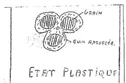
l'état plastique contient donc suffisamment peu d'eau libre intersticielle pour que les films d'eau absorbée autour de chaque grain se rejoignent et lubrifient les contacts entre les grains. Les tensions capillaires sont déjà très sensibles. Principe de l'essai: Teneur en eau exprimée en pourcentage du poids du matériau sec d'un fuseau de sol qui se brise en petits tronçons au moment où son diamètre atteint 3 mm.
