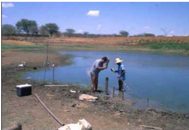
Foto 5. Instalação de um piezômetro na vazante do açude de Flocos.
