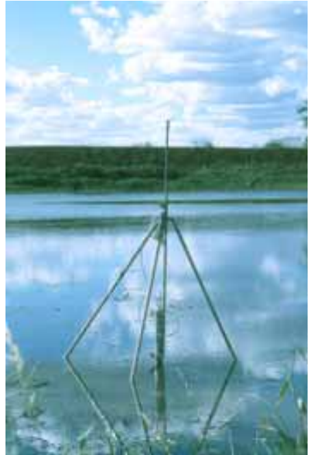
Foto 6. Extrator de solução do solo com cápsula porosa de aço em operação.
