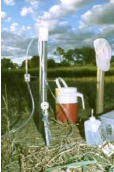
Foto 6. Extrator de solução do solo com cápsula porosa de aço em operação.
