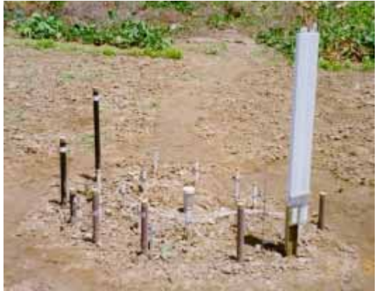
Foto 4. Sítio tensiométrico instalado na vazante do açude de Cajueiro.
