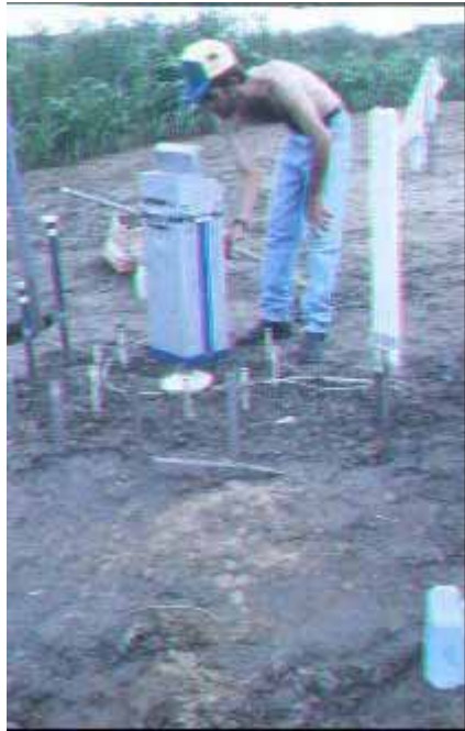
Foto 3. Medidas de umidade com a sonda de neutrons.
