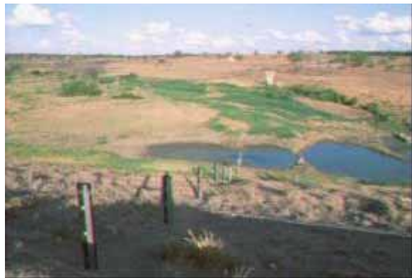
Foto 14. Réguas limnométricas pouco antes do açude secar, em agosto de 1998.
