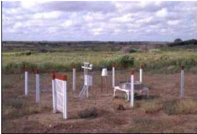
Foto 7. Estação meteorológica localizada próximo ao açude Cajueiro.
