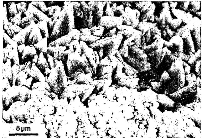
Foto 14 - Formas romboédricas exibidas por cristais de fosfato do grupo da crandallita, vistas em M.E.V
