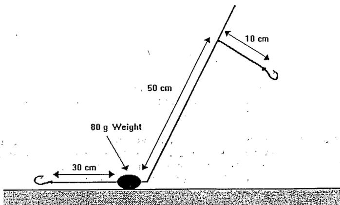
Figure 3: montage des lignes de pêche expérimentale
