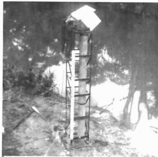
INSTALLATION D'UN LIMNIGRAPHE SUR LA RIVIERE AWEBE STATION D'ATOGA-FINA
