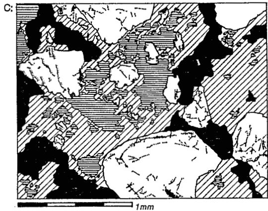
Figure 3 : Description microscopique de la transition "jaune compact-jaune poreux".
