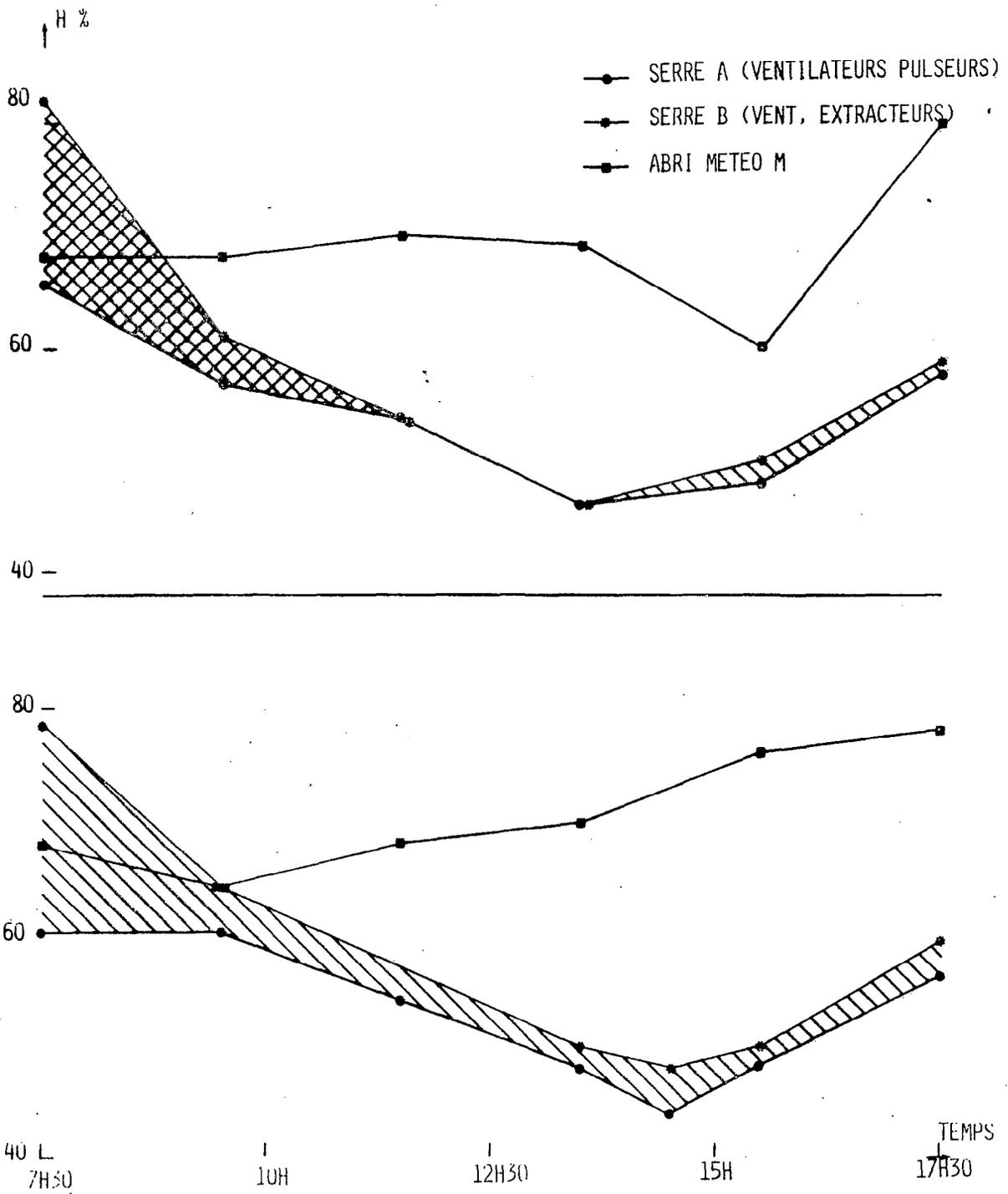
FIG. 16 - COURBES COMPARATIVES DES HUMIDITES A L'INTERIEUR DES SERRES ET SOUS ABRI AVEC ARROSAGE DU SOL CIMENTE DE LA SERRE A.
