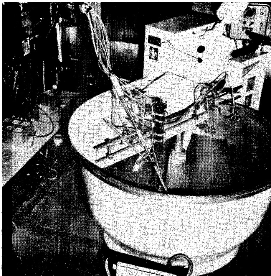
Fermenteur pilote (520 litres). Le cliché montre les jauges ( ^{\circ} , pH) et le dispositif de pulvérisation d'eau. Le fermenteur est disposé sur une balance permettant de contrôler la teneur en eau du substrat
