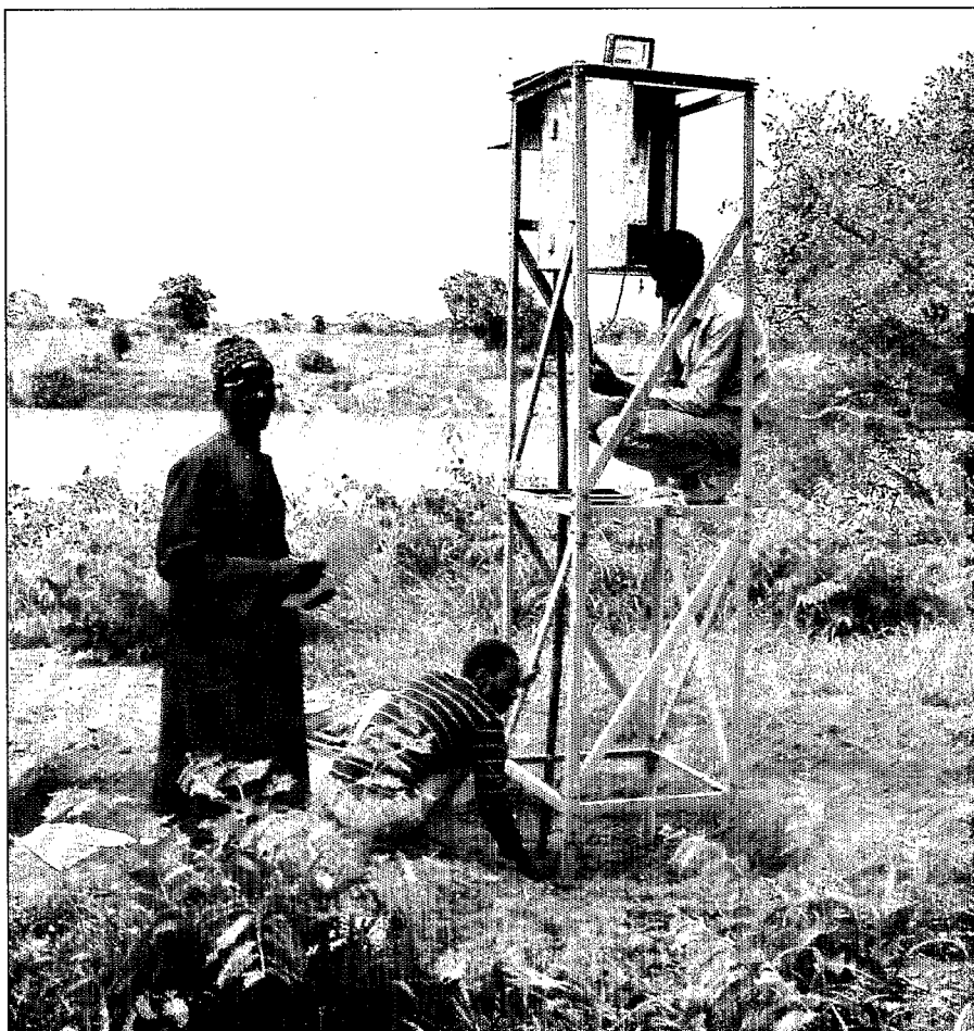
Station de Gourbassi. Sur le Sénégal, une des stations limnigraphiques qui permettent la télétransmission en temps réel (par satellite) des données hydrométriques nécessaires à la gestion du système d'eau.
