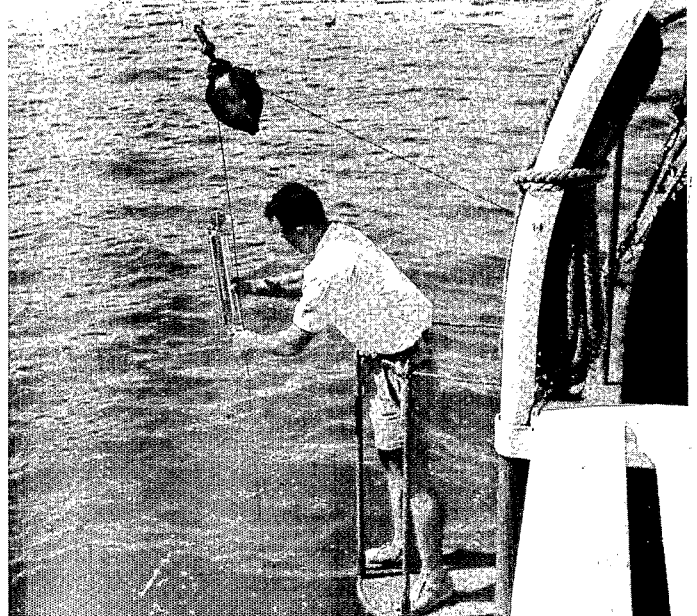
Ci-dessous : Debout sur une plateforme qui déborde à l'extérieur de l'ORSOM III, un homme met en place sur le câble du treuil océanographique une "bouteille à renversement" qui permet la récolte d'un échantillon d'eau à la profondeur choisie.
