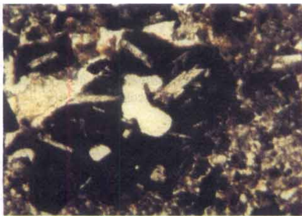
Fig. 8. Micro-estructura de una cinerita no alterada (NIJ7). Microscopia óptica, luz natural.
